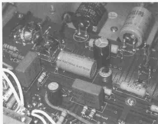
WIMA MKP 电容和 PHILIPS 电解电容对校声都有好处
