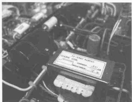
电源部分的扼流圈可有效提高稳压效果
